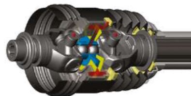
Le verrouillage par bague à billes automatique (RTA)
